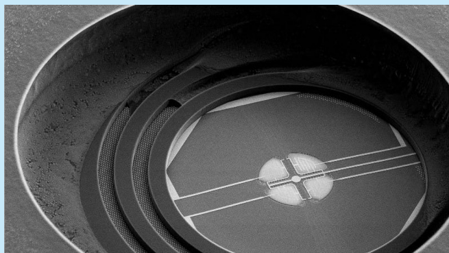
Rysunek 3. Widok budowy wewnętrznej czujnika SGP30 firmy Sensirion [7]
